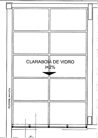
3 PLANTA DE COBERTURA - CLARABOIA ESCALA 1/25
